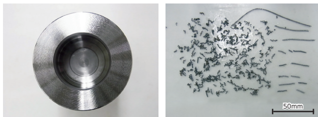
切りくずが細かくワーク穴に残らない No chip remains after machining
